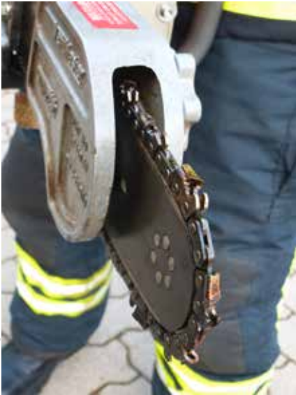
► Gefährliche Kette mit Aufpanzerungen
